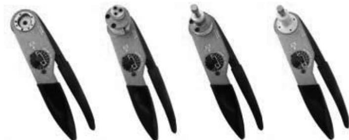
可选用的定位器包括美军标 M22520/1 系列定位器，TH 系列三定位芯转塔定位器，UH2 螺旋可调节定位器，Deutsch HTD-48 型螺旋可调节定位器，TP 系列固定定位器，J 系列大孔径定位器
